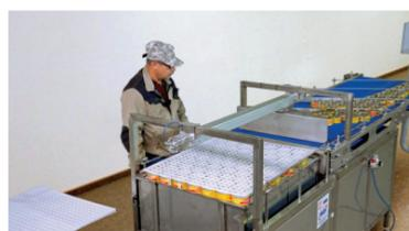
Полуавтоматические Линии Разгрузки
