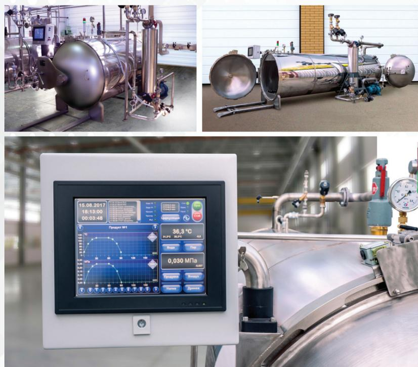
Горизонтальные автоклавы серии АГ-1200, выпускаемые нашим предприятием, зарекомендовали себя надежностью и удобством в эксплуатации. Надежность обеспечивается применением качественных материалов и комплектующих, современных технологий аргоно-дуговой сварки, высоким профессиональным уровнем персонала.
