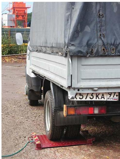
Весы подключаются к ПК по интерфейсу RS-232 / RS-485.
