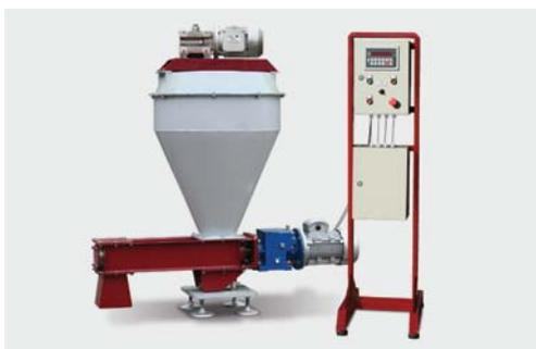
Дозатор с каждым отвесом выполняет автоматическую подстройку для адаптации к меняющимся условиям и увеличения точности дозирования.
