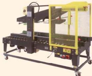
Оборудование предназначено для точного и аккуратного склеивания коробок при помощи скотча, горячего и холодного клея. Автоматический заклеивщик может поставляться в комплекте с оборудованием для укладки в коробки и формирователем коробок.
