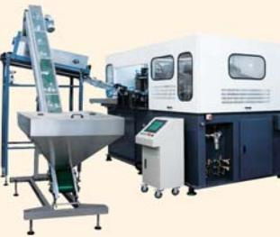
Оборудование данной серии характеризуется высокой степенью автоматизации, производительности и надежности. Оборудование является стабильным и безопасным. Автомат для выдува тары можно легко интегрировать в линию розлива или поставить в составе полной линии розлива. На автоматах можно производить ПЭТ-бутылки объемом от 0,25 л до 19 л.
