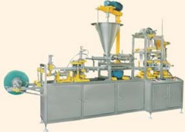
Оборудование предназначено для формирования пластиковой термоформируемой тары, дозирования в нее продукта и закрытия алюминиевой фольгой. Формируемая тара от 4 до 30 л применяется для таких продуктов как сливочное масло, мед, плавленый сыр, джем, мarmелад. Оборудование очень простое в эксплуатации и может обслуживаться одним человеком.
